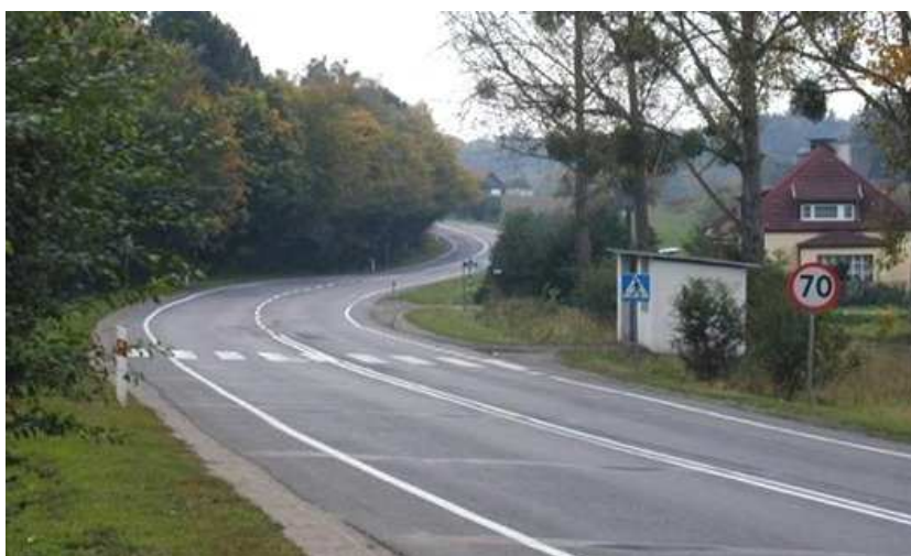
Fot. 2. Oznakowanie poziome. Linia pojedyncza przerywana, linia podwójna ciągła, linie krawędziowe ciągłe, przejście dla pieszych.
